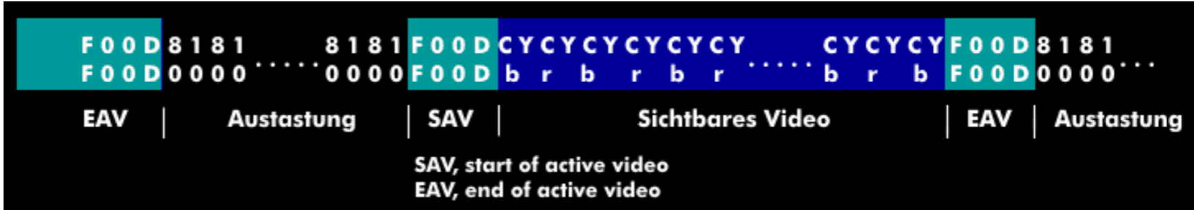
Videozeile eines BT.601-Signals nach BT.656
