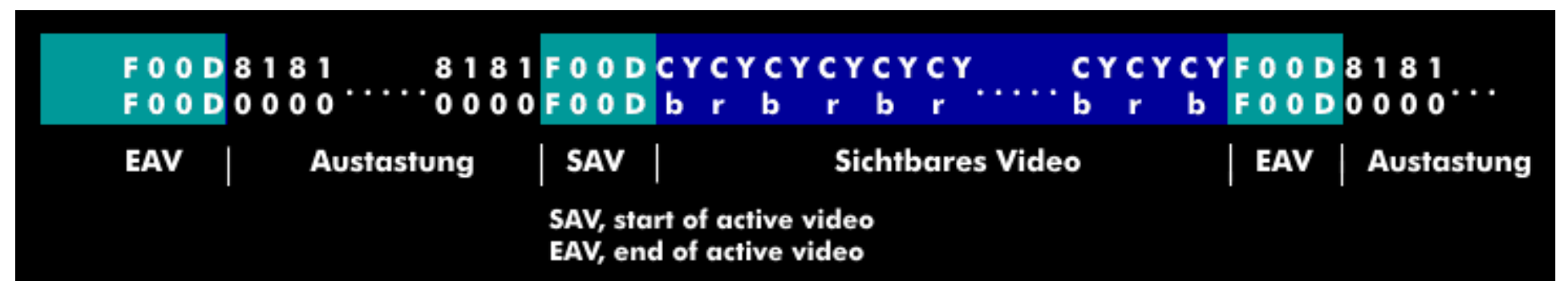
Videozeile eines BT.601-Signals nach BT.656
